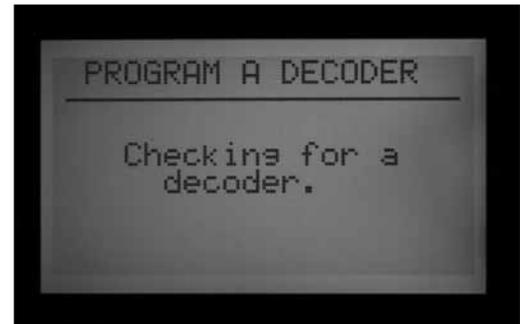
7. Das Decoderausgangsmodul prüft, ob ein Decoder angeschlossen ist. Wenn die Kabel korrekt mit dem Programmiersanschluss verbunden sind, werden im Bildschirm die Decodereinstellungen angezeigt.
