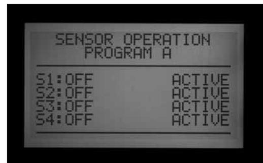
SUSPEND ist die empfohlene Einstellung für Bewässerungsprogramme, die bei Sensorsignal abschalten sollen.
