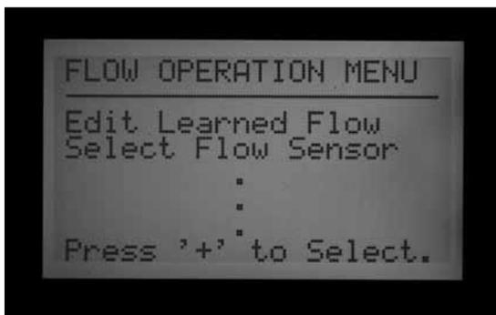
Als Anschlussstelle ist normalerweise das Steuergerät vorgegeben. Falls am Steuergerät ein ADM99-Decoderausgangsmodul installiert ist und Sie den Durchflussmesser an einen ICD-SEN Sensordecoder anschließen möchten, navigieren Sie mit der Pfeiltaste zu Location (Anschlussstelle) und wählen Sie mit der Plus- oder Minustaste ADM. So wird ein einzelner Durchflussmesser einem ICD-SEN Decoder auf dem Zweileiter-Kabelweg zugeordnet (und nicht den Durchflussschleifen am Leistungsmodul des Steuergeräts).
