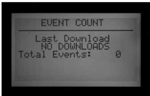
EVENT COUNT (Ereigniszähler): Hier sehen Sie die Gesamtanzahl der heruntergeladenen Ereignisse. Diese Funktion ist nützlich, um zu bestätigen, dass ein Paket Systemereignisse vollständig vom Steuergerät heruntergeladen wurde. Die Gesamtzahl sollte mit der Gesamtzahl der Ereignisse der Surveyor-Software übereinstimmen.
