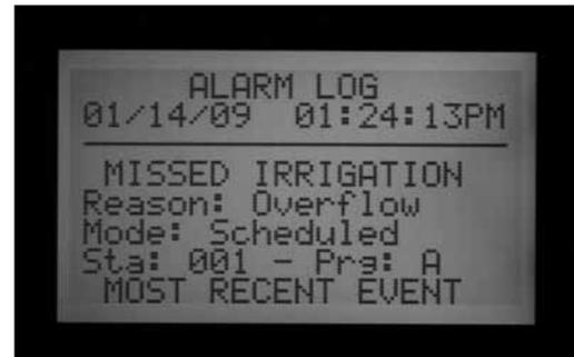
Mit „Missed Irrigation“ (versäumte Bewässerung) gekennzeichnete Alarm-Logs sind wichtig, da in diesen Fällen vorgesehene Bewässerungen bestimmter Stationen nicht stattfanden. Der Grund hierfür ist stets angegeben, z.B. Overcurrent (elektrischer Überstrom) oder Overflow/Underflow (hydraulische Über- / Unterbewässerung). Eine vollständige Liste der möglichen Meldungen in den Alarm-Logdateien finden Sie am Ende dieser Anleitung.
