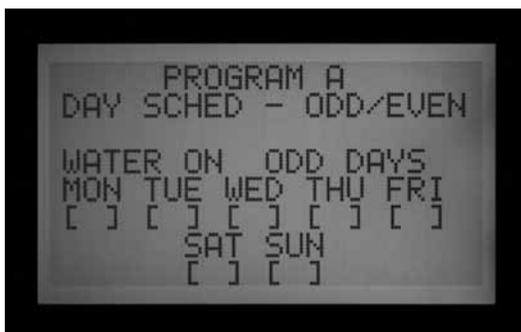
1. Wählen Sie das Programm und markieren Sie mit der Plus- oder Minustaste ODD/EVEN, wie oben im ersten Schritt gezeigt
