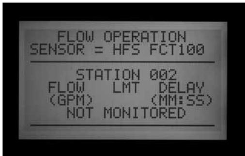
5. Wurden die Durchflusssensoreinstellungen nach dem Lernvorgang auf NONE umgestellt, so erscheint im Display die Meldung FLOW NOT MONITORED (Durchfluss nicht überwacht). Obwohl alle Stationen auf „nicht überwacht“ stehen, kann die aktuelle Durchflussmenge angezeigt werden. In diesem Fall ist die Alarmdiagnose auf Stationsebene nicht verfügbar, aber die Durchflussmenge wird dennoch angezeigt.
