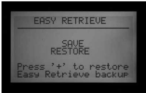
Damit sichern Sie die komplette Einstellung des Steuergerätes, einschließlich der Programme, Startzeiten, Laufzeiten usw. an einer sicheren Stelle im Speicher des Steuergeräts.
