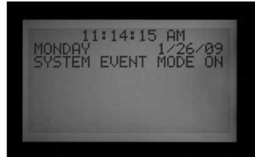
In der normalen FCP-Betriebsart erscheint keine bestimmte Anzeige; das Steuergerät befindet sich in dieser Betriebsart, solange in der Position RUN nicht SYSTEM EVENT MODE ON angezeigt wird.
