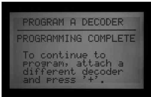
10. Nach erfolgreicher Programmierung (des Decoders) erscheint zunächst die Anzeige PROGRAMMING COMPLETE (Programmierung abgeschlossen) und danach der Hinweis zum eventuellen Programmieren eines weiteren Decoders.
