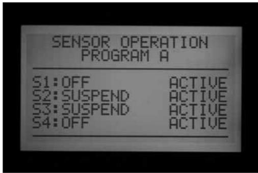
PAUSE bedeutet, dass das Steuergerät die Bewässerung solange stoppt, bis sich der Sensorzustand wieder ändert und der Sensor die Bewässerung wieder erlaubt (Rückstellung in den Normalzustand), wonach die Bewässerung wieder dort aufgenommen wird, wo sie unterbrochen wurde.
