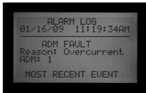
Die P/MV (Pumpe/Hauptventil) Ausgänge haben einen maximalen Ausgangsstrom von 0,325 A. Pumpenstartrelais mit hohem Strombedarf benötigen gegebenenfalls für einen zuverlässigen Betrieb einen eigenen Transformator und ein zusätzliches Relais (z.B. das Hunter Modell PSRB).
