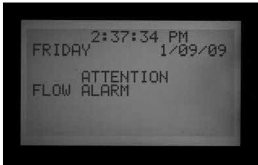
Nach beendeter Bewässerung erscheinen die Alarme weiterhin solange in der Anzeige, bis man eine beliebige Taste drückt. In der Regel sind mehrfache Durchflussalarme die Folge, da das ACC nach einer Pauseminute einen Neustart der Stationen versucht.
