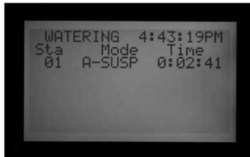
Ausgesetzte (Suspended) Programme zeigen weiterhin die Stationen an und zählen die verbleibende Zeit, aber es findet keine Bewässerung statt und neben dem Buchstaben des Automatikprogramms erscheint SUSPEND. Wird der Sensor neu gestartet, wird die Bewässerung sofort an dem Punkt wiederaufgenommen, an dem sie in der Echtzeit sein sollte.
