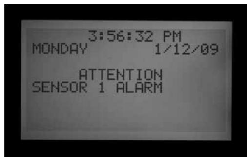
Zum Löschen der Alarmmeldung betätigen Sie die Plustaste und überprüfen Sie den Status der Programme. Das Betätigen der Plustaste löscht nur die Meldung, stellt aber nicht den Alarm zurück. Im Display wird nun der Status der Programme als Reaktion auf den Sensor angezeigt.
