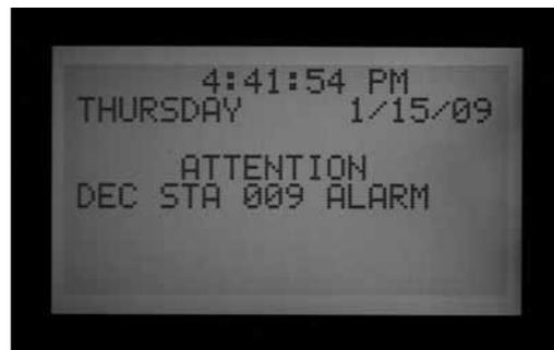
Eine ADM-Überstrommeldung bedeutet, dass der gesamte Stromfluss des Zweileiter-Kabelwegs 2,2 A überschreitet, ohne dass das ADM99 eine bestimmte Station als Problemursache identifizieren konnte.
