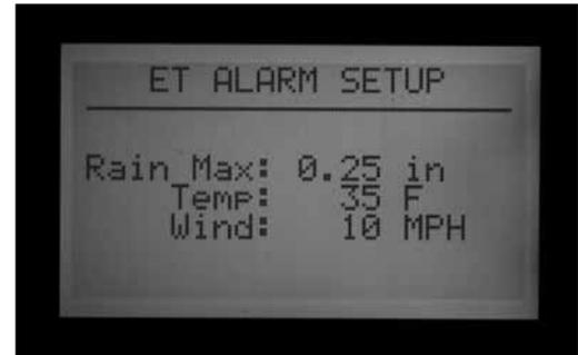
Der ET-Regensensor schaltet die Programme nach einer gemessenen Niederschlagsmenge von 0,51 mm in einer Stunde ab (diese Menge ist nicht programmierbar), aber man kann dem Programm den erneuten Betrieb gestatten, falls kein weiterer Regen mehr festgestellt wird. Der ET-Sensor prüft alle 15 Minuten auf Regen.
