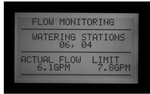
Wenn das Steuergerät einen Durchflussalarm feststellt, beginnt es mit der Diagnose (die im Display zu sehen ist).
