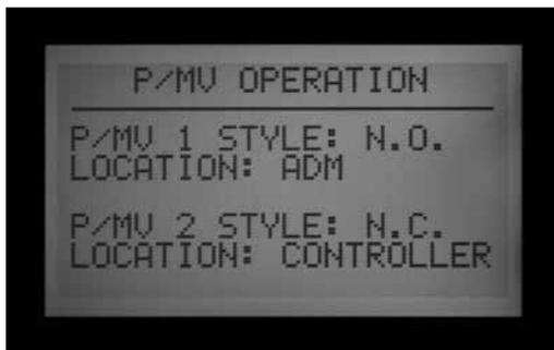
Die Anschlussstellen (Location) lassen sich nur bei Decoder-Steuergeräten verändern. In einem Decoder-Steuergerät kann man die Anschlussstellen von Steuergerät auf ADM (Decodermodul) umstellen. Die
