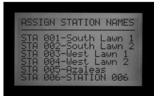
5. Zum Speichern der Namen drehen Sie den Wahlschalter in eine andere Schalterposition.
