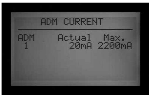
Hier sehen Sie den Stromaufnahme in Milliampere (mA) aller am Decoderausgangsmodul (ADM) angeschlossenen Decoder. Dieser Wert wird zu Diagnosezwecken verwendet.
