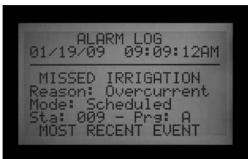
In der Alarm-Logdatei ist angegeben, ob der Alarm an einer bestimmten Stationsnummer auftrat, oder es erscheint ADM für das ADM99 Decoderausgangsmodul.
