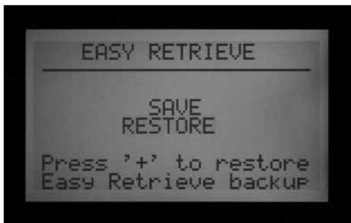
SAVE erscheint hervorgehoben. Speichern Sie das Programm durch Drücken der Plustaste; eine Bestätigungsmeldung erscheint. Mit der Minustaste können Sie das Erstellen der Sicherheitskopie noch abbrechen, oder Sie leiten sie mit der Plustaste ein. Durch Druck auf die Plustaste wird die Speicherung abgeschlossen.
