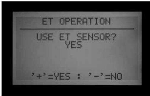
Nach Zurückdrehen des Wahlschalters auf RUN sehen Sie die Anzeige Current ET: x.xx (gegenwärtige ET: x.xx) in Inches oder Millimetern. Ist ET-Operation (ET-Betrieb) in der Stellung YES freigegeben, so sind am Startbildschirm von ET FUNCTIONS weitere Wahlmöglichkeiten unter ET FUNCTION verfügbar.
