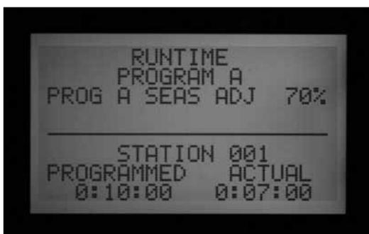
Wählen Sie am Wahlschalter unter SET STATION RUN TIMES (Stationslaufzeiten einstellen) eine Station und drücken Sie die Informationstaste. Eine Zusammenfassung aller Bewässerungsvorgaben für diese Station, einschließlich der Angabe aller Programme in denen diese Station laufen wird, erscheint.
