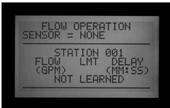
Halten Sie die Informationstaste gedrückt, während Sie den Wahlschalter auf SET FLOW MONITORING (Durchflussüberwachung einstellen) drehen. Sobald der Cursor auf SELECT FLOW SENSOR (Durchflusssensor wählen) blinkt, drücken Sie die untere Pfeiltaste.
