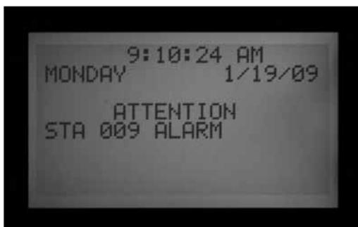
Bei Decoder-Steuergeräten kann eine elektrische Überlastung aufgrund komplexer Ursachen auftreten, aber auf jeden Fall zeigt einen unzulässig hohen Strom in der Decoderleitung an.
