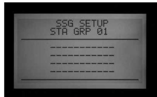
6. Die erste mögliche SSG wird als STA GRP 01 angezeigt; es erscheinen vier Zeilen (gestrichelte Zeilen bei einer Neuinstallation, Stationsnummern bei bereits programmierten Stationen). Jede Zeile steht für eine Station, also ein mögliches SSG-Mitglied.
