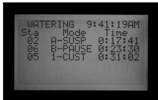
Die Station 02 lief in Programm A und dieses Programm wurde ausgesetzt (Suspended): Der Sekundenzähler läuft weiter, aber die Bewässerung wurde gestoppt.
