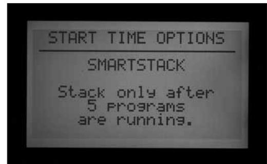
SmartStack begrenzt die gleichzeitigen Operationen auf die hier angegebene Stationsanzahl. Es lassen sich so viele überlappende Programme wie gewünscht programmieren, aber das Steuergerät erlaubt Überlappungen nur bis zur hier angegebenen Zahl; der Rest wird aufgeschoben (muss warten).
