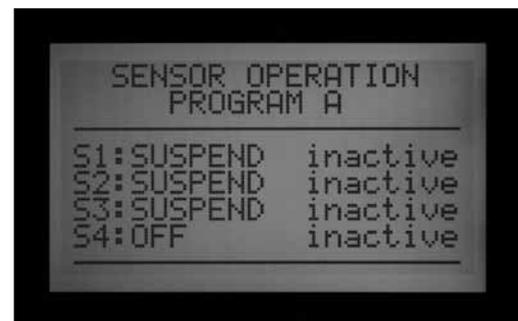
Abschaltungen über einen ET-Sensor erfolgen nicht sofort. Zwischen einem ET-Sensoralarm und der Abschaltung kann eine Verzögerung von bis zu 18 Minuten liegen. Falls eine solche Verzögerung nicht akzeptabel ist, sollten Sie einen separaten Sensor (zum Beispiel einen Rain-Clik oder Freeze-Clik) installieren und für sofortige Abschaltung direkt an einen der vier Eingänge Sen 1-4 anschließen.
