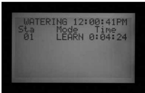
Nur für Stationen mit Laufzeiten in einem Automatikprogramm werden Durchflussmengen erlernt. Stationen ohne Laufzeit in einem der Programme werden hierbei ausgelassen und sollten zur Gewährleistung eines ordnungsgemäßen Betriebs des Durchflussmessers auf NOT MONITORED (nicht überwacht) gestellt werden.
