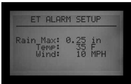
Ein ET-Regensensor schaltet die Sensoren nach 0,51 mm (0,02") Regen in einer Stunde ab (dieser Wert ist nicht programmierbar). Man kann dem Programm den erneuten Betrieb gestatten, falls kein weiterer Regen mehr festgestellt wird. Ein ET-Sensor prüft alle 15 Minuten auf Regen.
