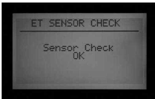
Falls die Abfrage fehlschlägt (ET-Sensor antwortet nicht), prüfen Sie die Verkabelung zum Sensor und wiederholen Sie den Vorgang. Beachten Sie beim Anschluss eines
