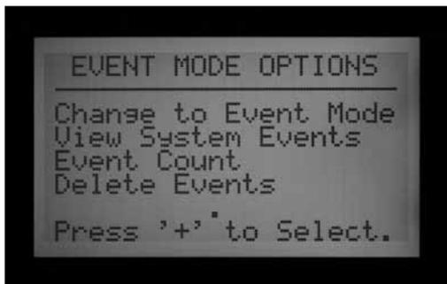
Drehen Sie den Wahlschalter auf ADVANCED FEATURES (Erweiterte Funktionen). Drücken Sie die Plustaste. Gehen Sie mit der Abwärtspfeiltaste zu EVENT MODE OPTIONS (Optionen der Betriebsart Ereignisse). Drücken Sie die Plustaste. Die erste Wahlmöglichkeit ist CHANGE TO EVENT MODE (In die Betriebsart Ereignisse wechseln).
