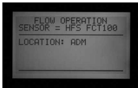
Wenn Sie einen Durchflusssensor von Data Industrial oder einen ähnlichen Sensor verwenden, drücken Sie die Plustaste, bis OTHER (andere) im Display angezeigt wird. Stellen Sie danach den K-Faktor und den Offset (Ausgleichswert) über die Plus-, Minus- und Pfeiltasten ein. Die entsprechenden Werte finden Sie in den Anleitungen von Data Industrial oder anderer Hersteller.
