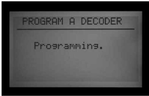
9. Sobald der Decoder korrekt eingestellt ist, drücken Sie die Programmtaste, um diese Eingabedaten zum Decoder zu senden. Für einige Sekunden erscheint die Anzeige „Programmings...“, bis die Daten an den Decoder übertragen worden sind.
