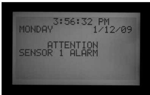
Steht der Sensor in allen Programmen auf OFF, so löst er keinen Alarm und keine Warnmeldung aus.
