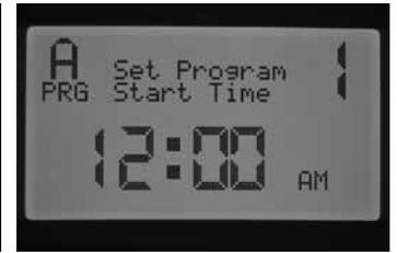
Wenn Sie eine Programmstartzeit überspringen (Beispiel: Sie richten nur Startzeit 1 und 3 ein), wird Ihre Eingabe zunächst akzeptiert. Sobald Sie den Drehschalter auf diese Position zurückstellen, werden die Startzeiten in eine lückenlose Abfolge gebracht (Startzeit 3 wird zu 2).
