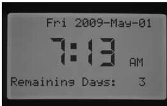
3. Stellen Sie den Drehschalter auf Betrieb. Das Display zeigt in der Schalterstellung Betrieb die Dauer der Bewässerungspause in Tagen an. Diese Zahl wird täglich um Mitternacht um einen Zähler verringert, so dass die verbleibenden Tage bis zur Fortsetzung der automatischen Bewässerung angezeigt werden.
