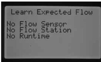
Bei unvollständiger Programmierung werden die für den Lernvorgang fehlenden Elemente am Display angezeigt.
