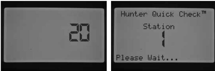
Das Steuergerät tastet alle Stationen ab, um über die Stationsklemmen Pfade mit erhöhtem Stromfluss zu erkennen. Wenn in der Feldverdrahtung ein Kurzschluss erkannt wird, zeigt das Steuergerät für jede fehlerhafte Station eine Fehlermeldung an.
