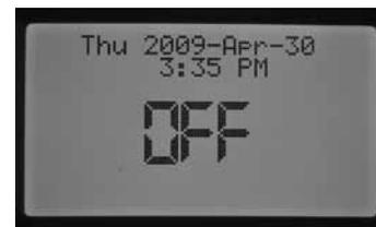
In der Schalterstellung SYSTEM AUS können Sie einen Zeitraum programmieren, in dem das Steuergerät ausgeschaltet bleibt. Diese Funktion wird im Abschnitt „Programmierbare Bewässerungspause“ beschrieben.
