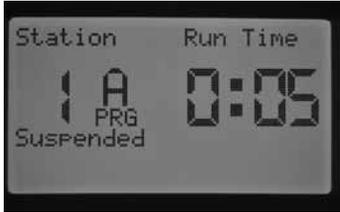
Unabhängig davon, ob die Sensorwirkung für eine Station aktiviert ist oder nicht, wird der Sensorstatus durch ein Fernbedienungs-signal für einzelne Stationen außer Kraft gesetzt, und die Bewässerung erfolgt über die gewünschte Laufzeit. Wenn Sie per Fernbedienung einen manuellen Programmbefehl auslösen, zeigt das Steuergerät die Stationen an, die auf Sensorwirkung programmiert sind. An diesen Stationen erfolgt keine Bewässerung. Sie befinden sich im Status „Ausgesetzt“.
