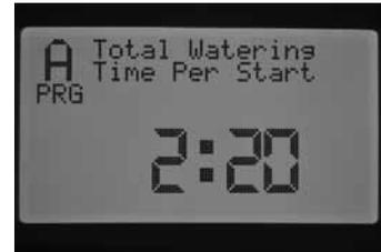
1. Stellen Sie den Drehschalter auf ERWEITERTE FUNKTIONEN. Navigieren Sie mit ▲ und ▼ zu GESAMTBEWÄSSERUNGSDAUER, und drücken Sie die Taste +, um diese Option auszuwählen.
