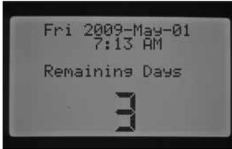
2. Drücken Sie dann die Taste + / -. Das Steuergerät schaltet in den Modus Verbleibende Tage. Stellen Sie mit den Tasten + / - die gewünschte Anzahl an Tagen für die Bewässerungspause ein. Nach diesem Zeitraum wird die automatische Bewässerung fortgesetzt. Die Bewässerungspause kann zwischen 1 Tag und 180 Tagen dauern.
