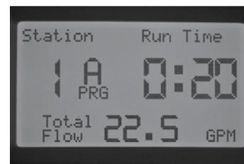
Das Steuergerät schaltet die Station ab und legt eine Pause von etwa einer Minute ein, damit sich die Durchflussabweichungen von selbst regulieren können.
