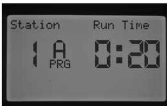
Die Stationslaufzeit blinkt nun. Wählen Sie mit der Taste ◀ oder ▶ die Station innerhalb des Programms aus, bei der Sie mit dem manuellen Betrieb beginnen möchten. Stellen Sie mit den Tasten + / - die gewünschte Laufzeit für die Stationsnummer ein, die angezeigt wird. Alle nachfolgenden Stationen werden mit den programmierten Laufzeiten des automatischen Programms ausgeführt.
