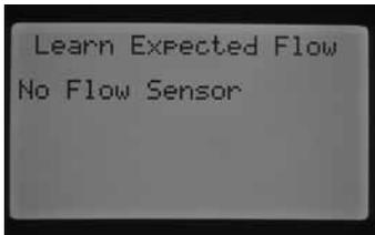
Wenn am Bildschirm Sensorenkonfiguration kein Sensor ausgewählt, kein Durchfluss zur Überwachung eingestellt oder keine Laufzeit programmiert ist, kann der erwartete Durchfluss nicht erlernt werden. Falls kein Sensor ausgewählt ist, wird am Bildschirm "Erwarteten Durchfluss" lernen die Meldung "Kein Durchflusssensor" angezeigt.
