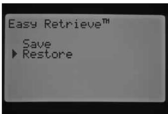
2. Drücken Sie einmal kurz die Taste +. Halten Sie anschließend die Taste + etwas länger gedrückt. Das wiederhergestellte Easy Retrieve-Programm wird nun aufgerufen. Auf dem Display werden Sie aufgefordert zu warten. Anschließend erscheint die Meldung, dass das Easy Retrieve-Programm erfolgreich wiederhergestellt wurde.
