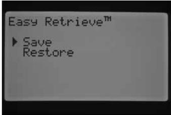
3. Drücken Sie einmal kurz auf die Taste +, und halten Sie anschließend die Taste + gedrückt. Die aktuelle Programmierung wird nun als Easy Retrieve-Programm gespeichert. Auf dem Display werden Sie aufgefordert zu warten. Anschließend erscheint die Meldung, dass das Easy Retrieve-Programm erfolgreich gespeichert wurde.
