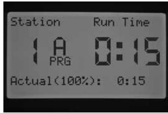
Mit der Taste PRG können Sie die Programme wechseln, während Sie bei derselben Station bleiben. Es wird jedoch empfohlen, dass Sie ein Programm bis zum Abschluss programmieren, bevor Sie zum nächsten Programm wechseln.
