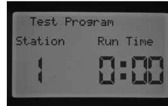
3. Zum Erhöhen der Testlaufzeit wählen Sie mit der Taste + einen Wert zwischen 1 Minute und 15 Minuten aus. Die Stationen werden für die ausgewählte Laufzeit aktiviert.
