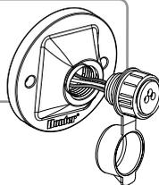
3. Schrauben Sie das SmartPort-Gehäuse wie abgebildet in das T-Stück.
