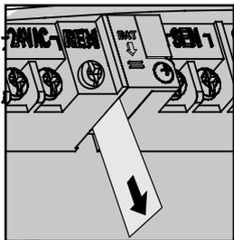
Stellen Sie sicher, dass Sie, nachdem Sie den X-Core installiert haben, den Isolator der Batterie entfernen, damit der X-Core bei Stromausfall nicht die Zeit verliert.
