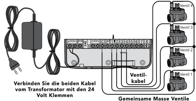
Verbinden Sie die beiden Kabel vom Transformator mit den 24 Volt Klemmen
