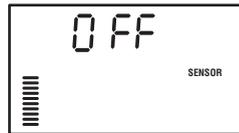
ermöglichen. Außerdem können Sie den Regensensor umgehen, wenn Sie den Drehschalter auf manuellen Betrieb schalten (Einstellung MANUELLER BETRIEB EINE STATION).
