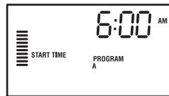
**HINWEIS:** Die Startzeiten können in beliebiger Reihenfolge eingegeben werden. Der Pro-C sortiert die Startzeiten automatisch in zeitlicher Abfolge, sobald Sie den Drehschalter von der Position **PROGRAMMSTARTZEITEN EINSTELLEN** in eine andere Position schalten.
